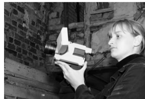
Mit der Wärmebildkamera werden die Temperaturverläufe in den Mauern gemessen
